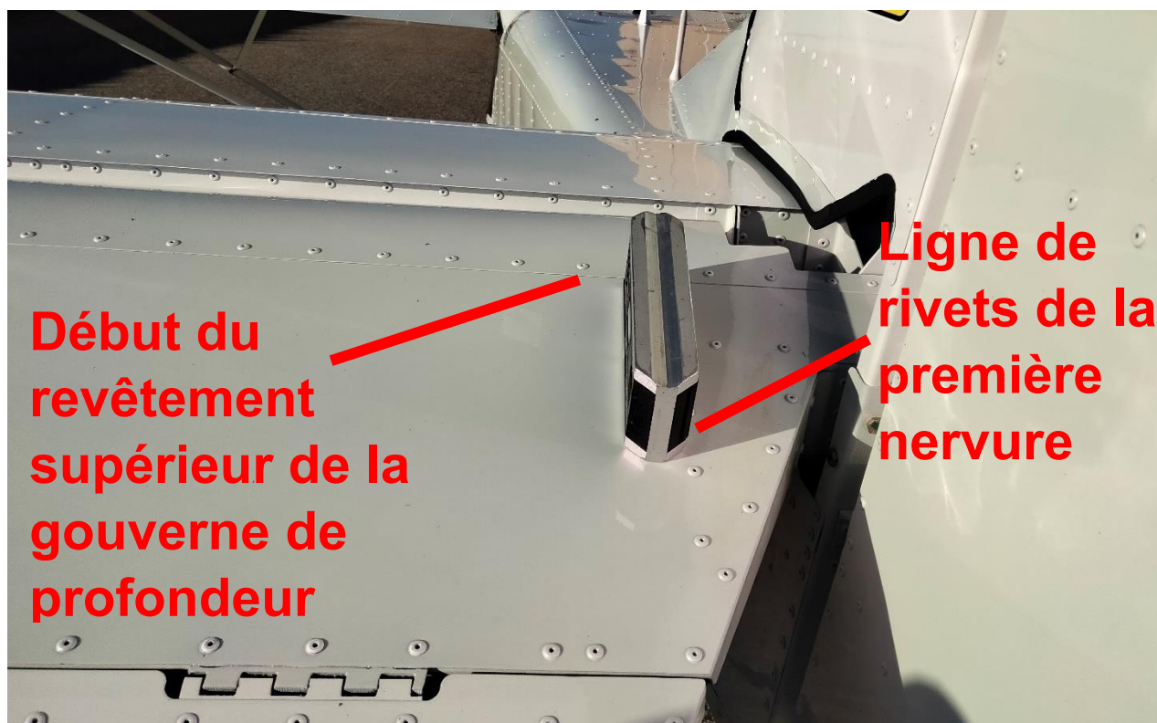
Figure 55: Position du niveau à bulle numérique sur la gouverne de profondeur
