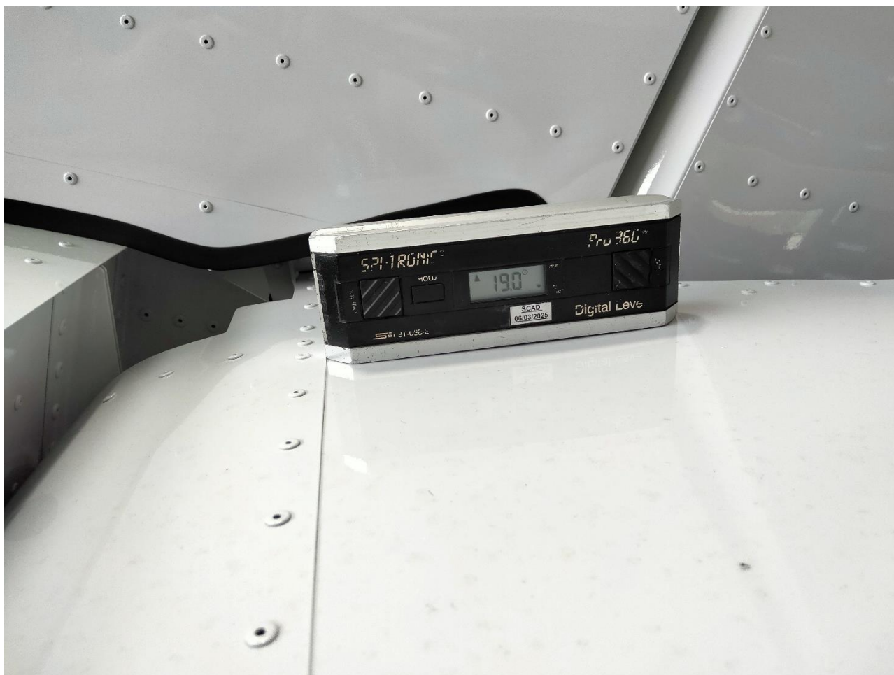
Figure 56: Réglage final de l'angle de débattement de la gouverne de profondeur
